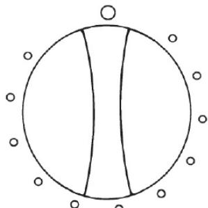
將定時器向順時鐘方向調節到所需要的乾衣時間，而乾衣熱度同時利用定時器設定。
