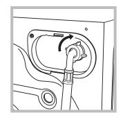
2. 將進水管的另一端連接洗衣機背部之右上位置。只需鬆開接頭配件,轉動軟管並重新緊固接頭配件,確保不漏水即可(見圖)。
