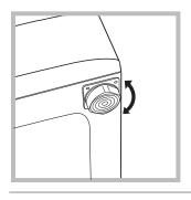
2. 若地板並非處於水平 狀態,通過左右旋轉 可調節機腳(見圖), 使本機水平放置。本 機工作面的坡度不能 超過2度。 正確調平機器能使本機穩定操作,有助避免振動和過大的噪音,並防止本機在運行時移位。如果將本機放在地毯上,請調整機腳,以便在本機下方留出足夠的通風空間。
